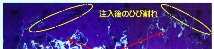
樹脂注入後荷重試験後の切断面 (0.05mm以上の複雑なひび割れ浸透)
