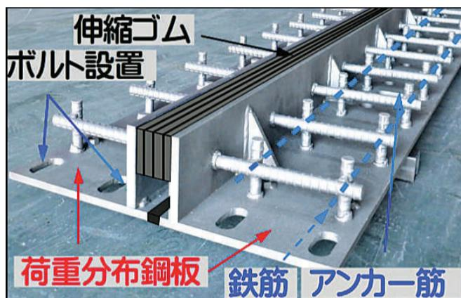
今回施工した荷重分布型伸縮装置(荷重支持型)の構造。5年前に突き合わせ型も施工しており、2タイプの施工実績となる
