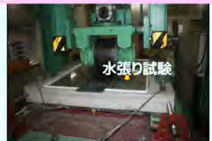
輪荷重走行試験機
