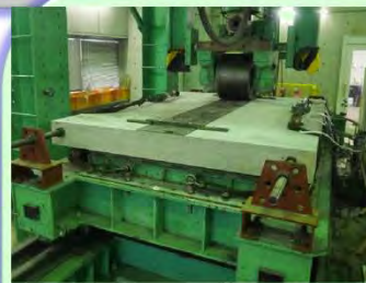
輪荷重走行疲労実験 (日本大学生産工学部)
