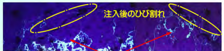
樹脂注入後载荷試験後の切断面 (0.05mm以上の複雑なひび割れ浸透)
