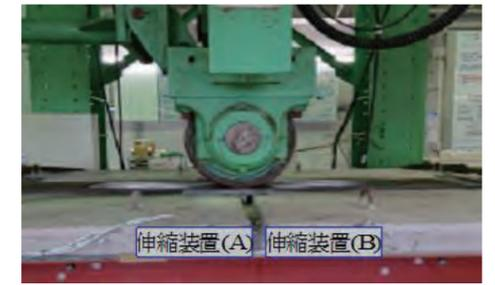
写真3 輪荷重走行疲労実験状況
