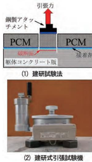
図6 建研式引張試験方法
